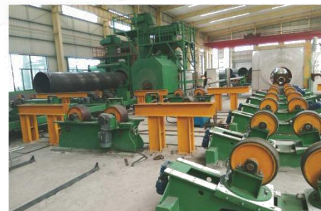
φ 426-φ 1620钢管3PE防腐生产线 φ 426-φ 1620 steel pipe 3PE anticorrosive production line
