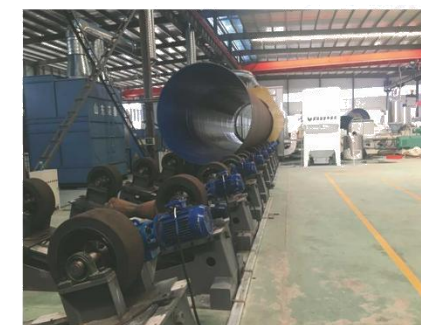
φ 800-φ 3200 TPEP螺旋输送系统 φ 800-φ 3200 TPEP screw conveyor system
