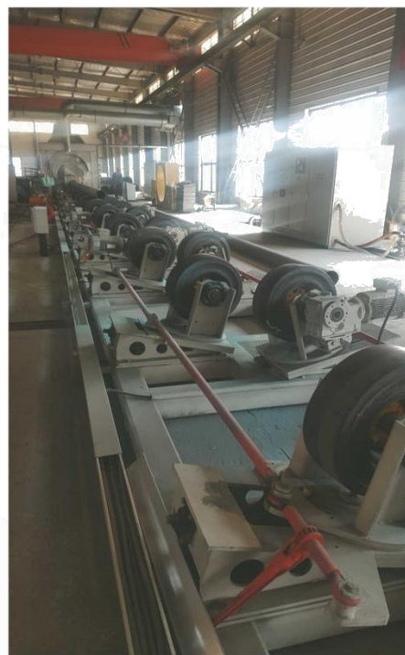
φ 159-φ 1020钢管3PE防腐生产线 φ 159-φ 1020 pipe 3PE anticorrosive production line
