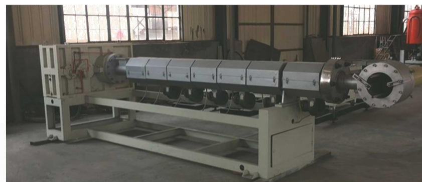
包覆3PE150挤出机 (φ 32 - φ 325) Coated 3 PE150 extruder (φ 32 - φ 325)
