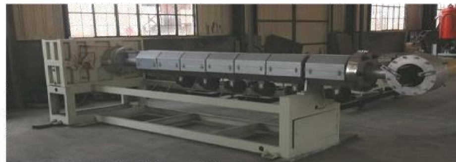
包覆3PE150挤出机 (φ 32-φ 325) Coated 3 pe150 extruder (φ 32 - φ 325)
